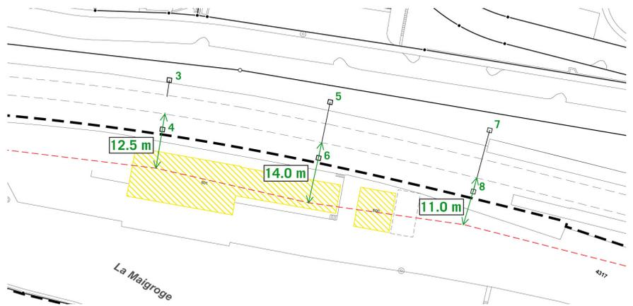
**Figure 25 :** Profil du champs magnétiques aux mâts n° 5 et 6 (source : CFF)
